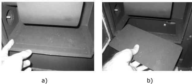
Figura 117 - limpeza do interior da salamandra
